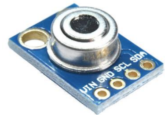
Abbildung 48: IR-Temperatur-sensor [MLX]
